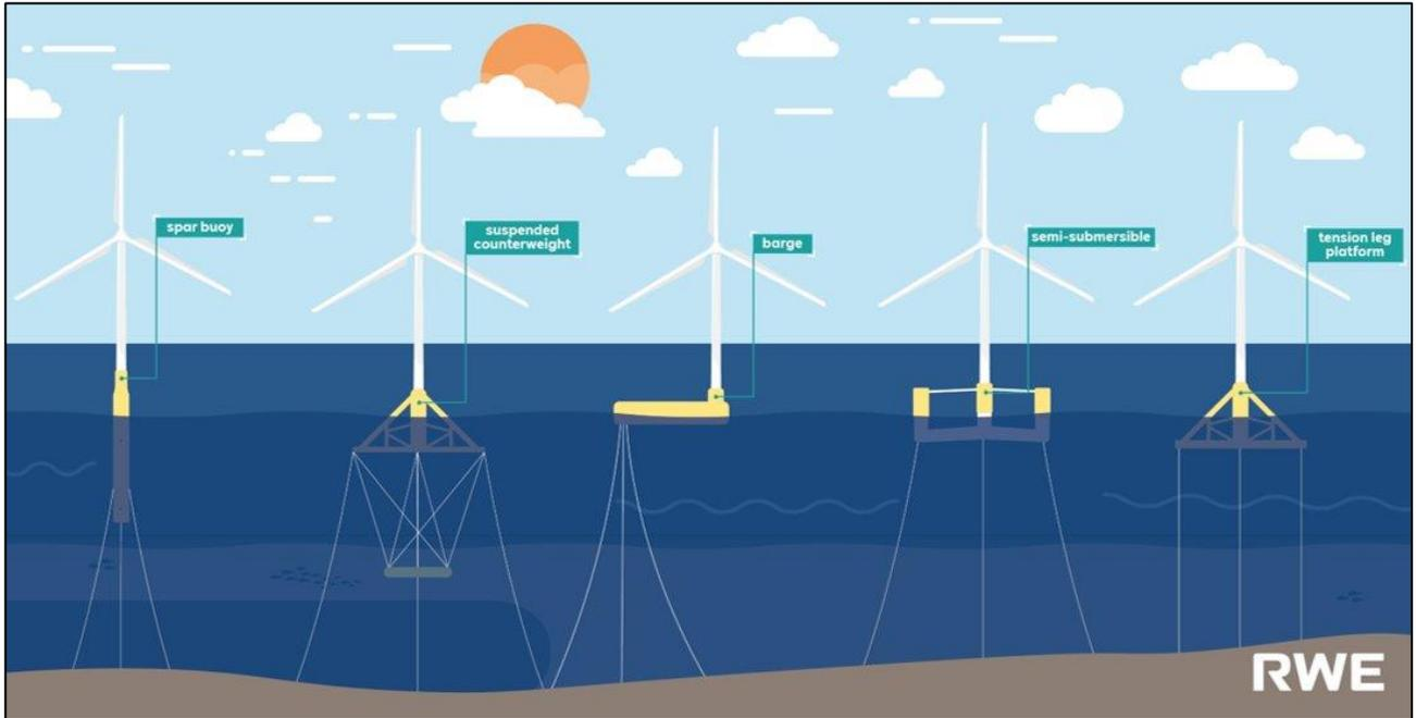
Figura 2-4: Tipologie di fondazioni galleggianti (alto) e struttura di galleggiamento della turbina (basso) (Fonte /a36/, Capitolo 10 )
