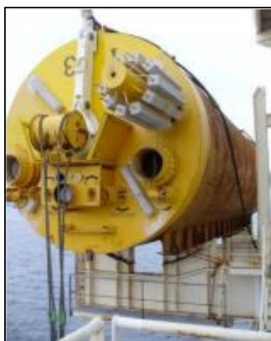
Figura 2-10: Illustrazione di palo infisso per aspirazione
