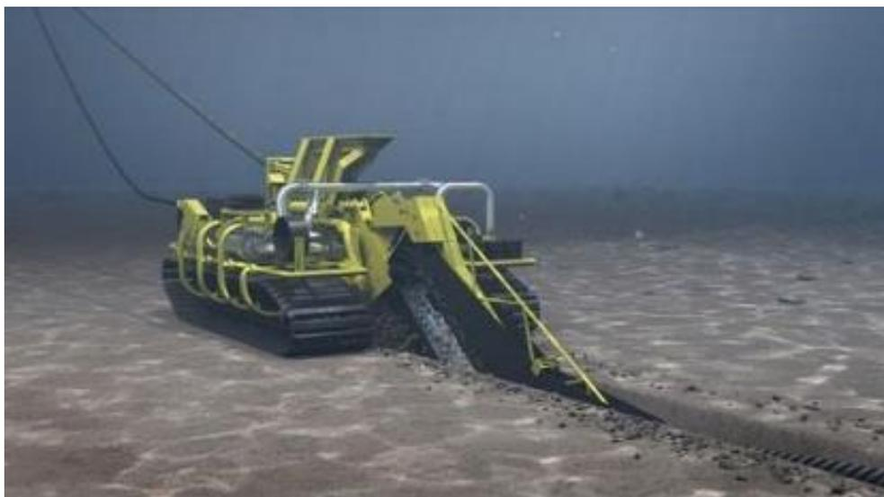
Figura 2-17: Sistemi protezione dei cavi per interramento
