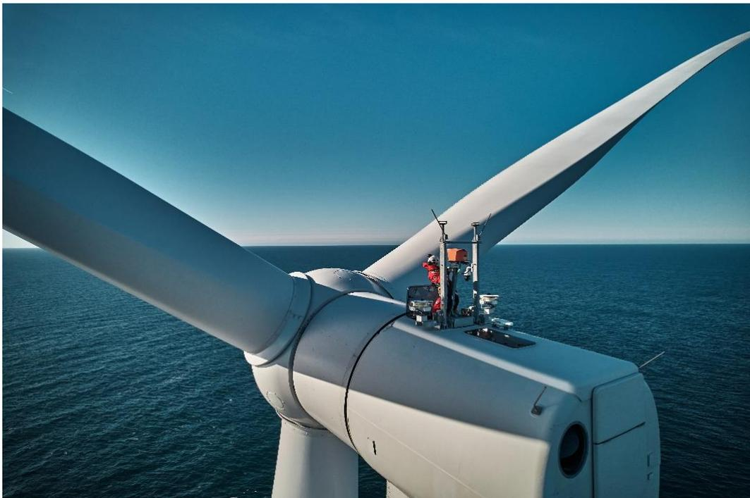
Il rotore della turbina eolica da 15MW ha un diametro massimo di 236 metri, con una superficie spazzata di 43'742m<sup>2</sup>.
