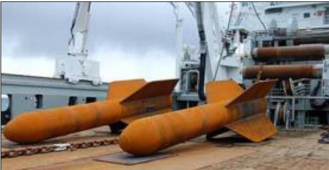
Figura 2-11: Illustrazione di pali a siluro
