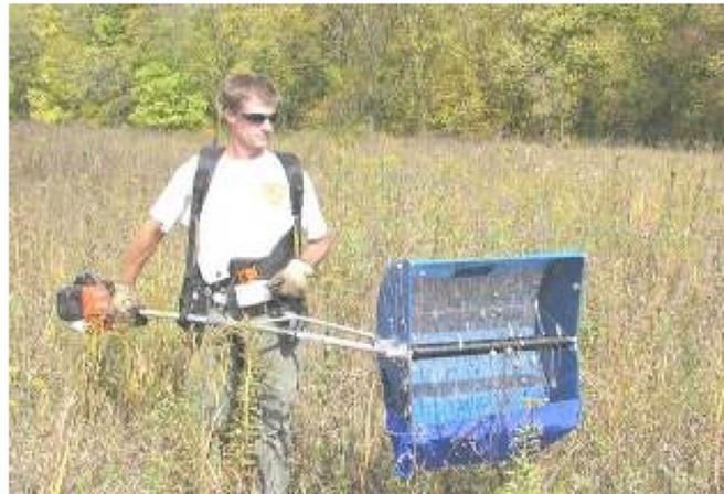
*Figura 3 - Esempio di macchina spazzolatrice a spalla*
