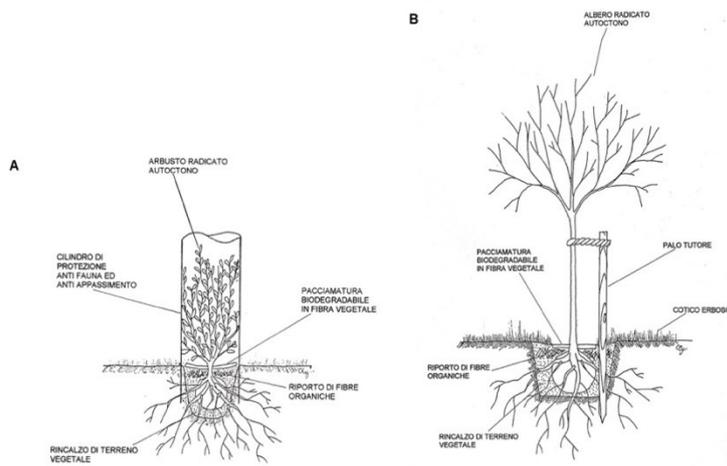
Figura 7 - Piantazione di arbusto radicato autoctono (A) e albero radicato autoctono (B)
