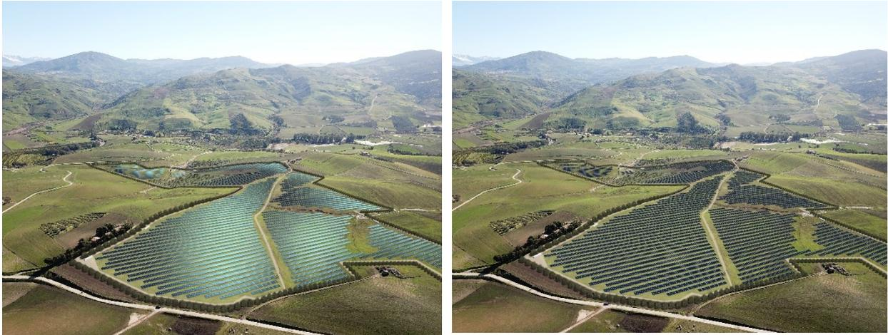
Figura 19 - Rendering sottocampi 2 e 3 con moduli in silicio policristallino (foto a sinistra) e con moduli con tecnologia antiriflesso in silicio monocristallino che saranno adottati (foto a destra)
