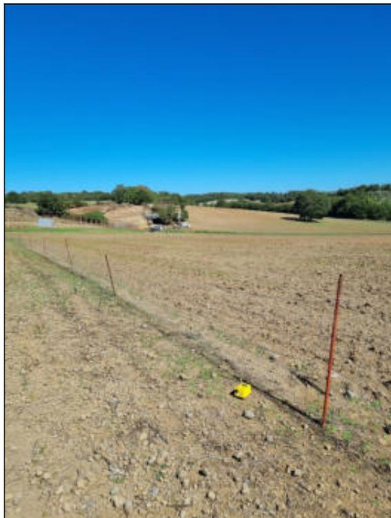
Foto 12: Esecuzione misura di microtremori HVSR1
