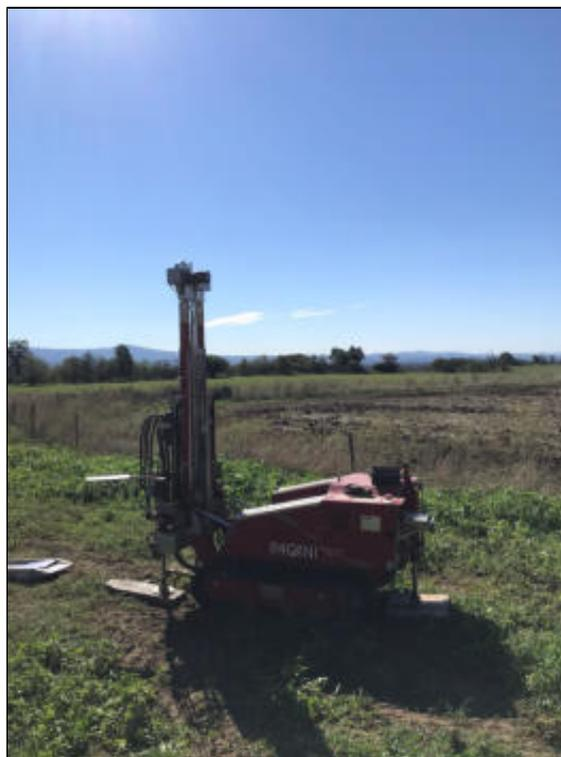
Foto 8: Esecuzione prova penetrometrica dinamica DPSH3
