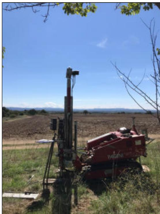
Foto 6: Esecuzione prova penetrometrica dinamica DPSH1
