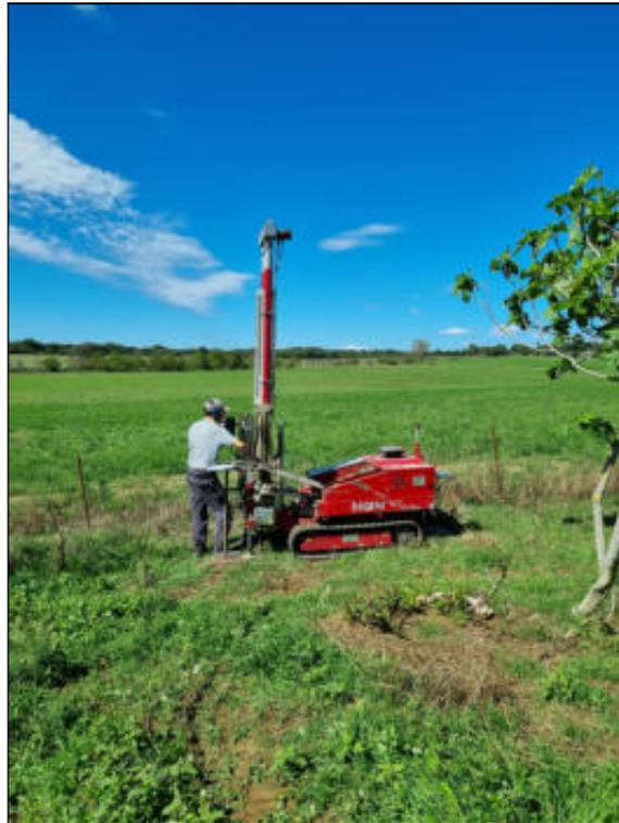
Foto 7: Esecuzione prova penetrometrica dinamica DPSH2
