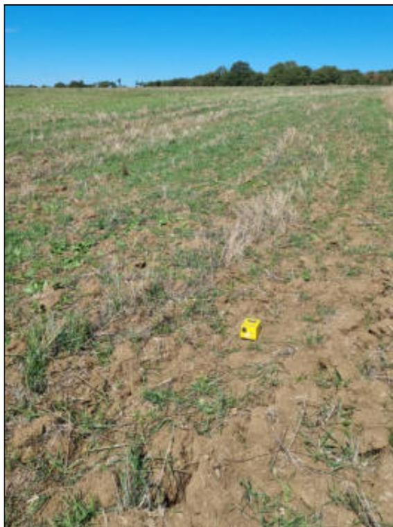
Foto 13: Esecuzione misura di microtremori HVSR2
