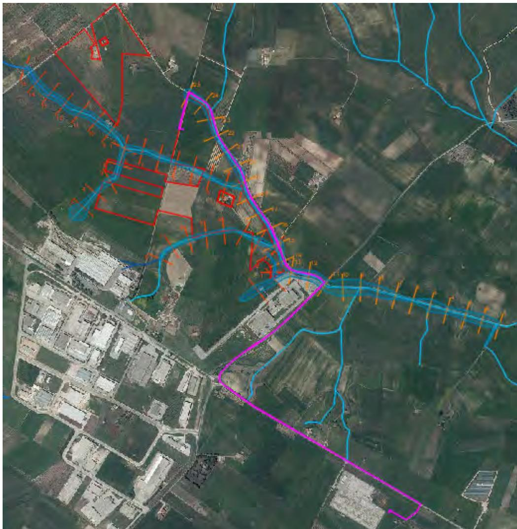
**Figura 7 – Planimetria con indicazione delle aree inondabili duecentennali.**
