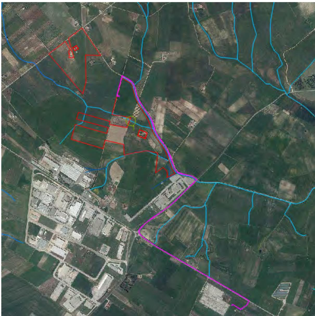
**Figura 5- Sovrapposizione del reticolo idrografico e cavidotto – n.1 attraversamento**
