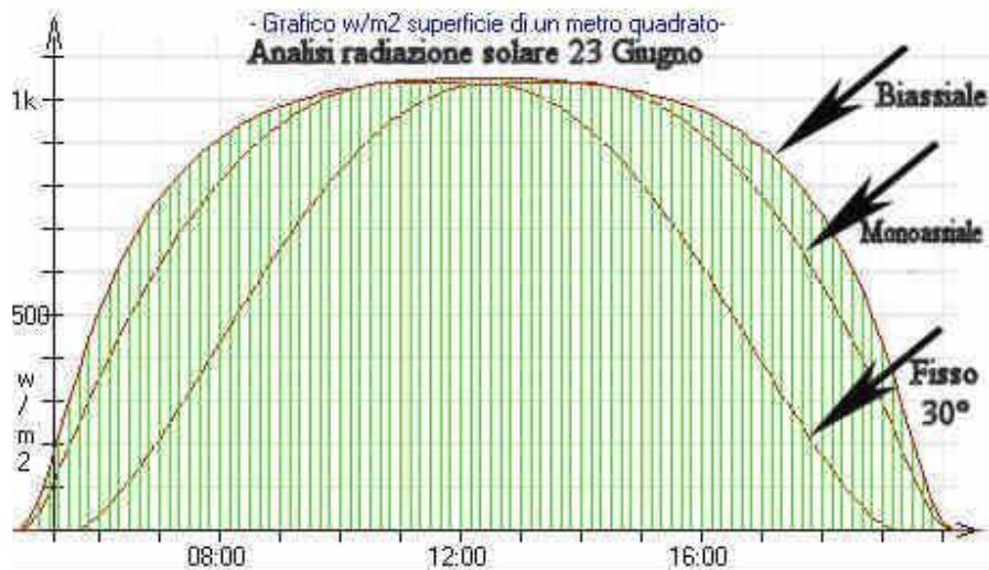
Figura 175: Confronto tra sistemi di produzione fisso-inseguimento monoassiale – inseguimento biassiale
