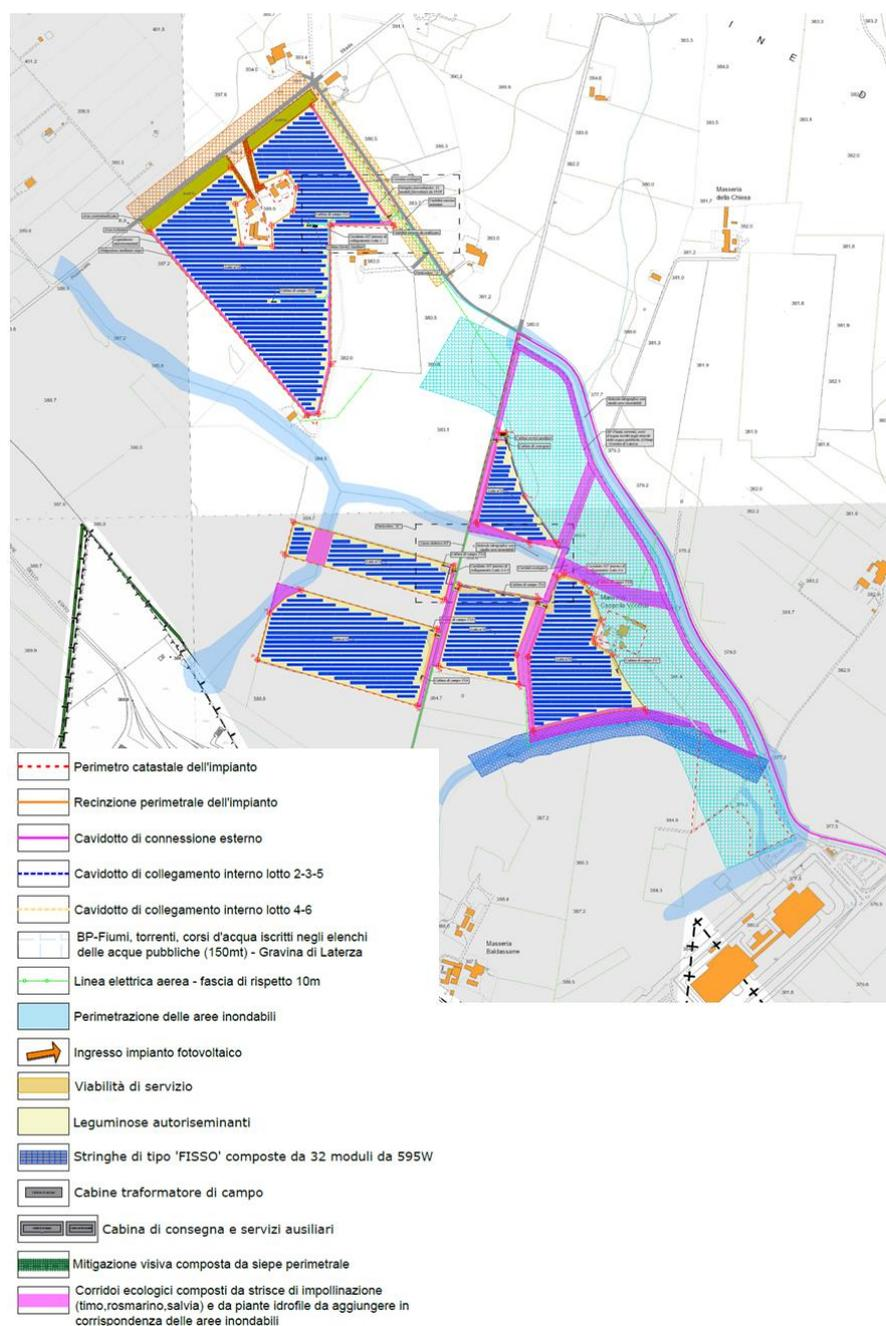
Figura 63: Layout impianto con misure di mitigazione e opere a verde
