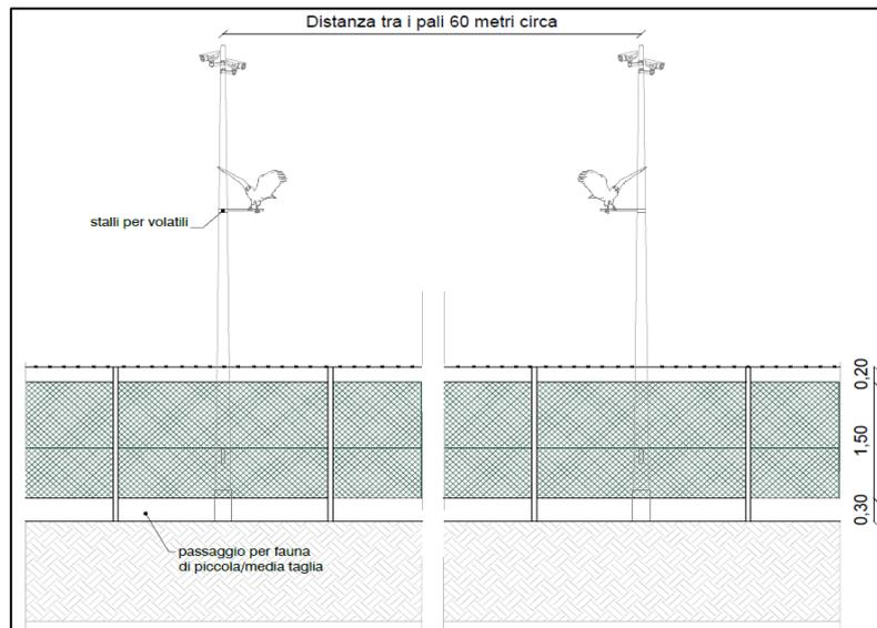
Figura 58: Tipologico recinzione - sezione trasversale
