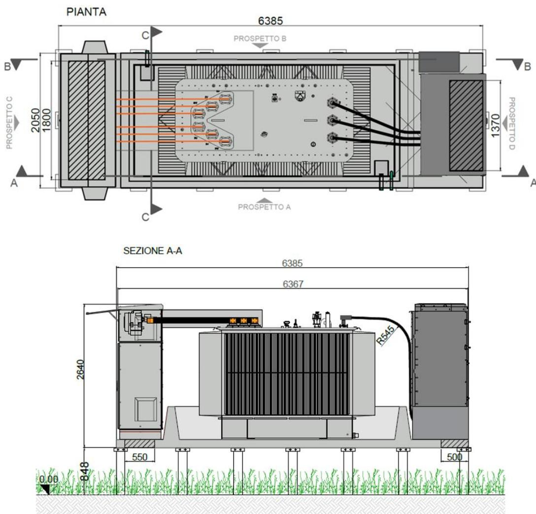
Figura 53: Planimetria e sezioni della cabina di campo
