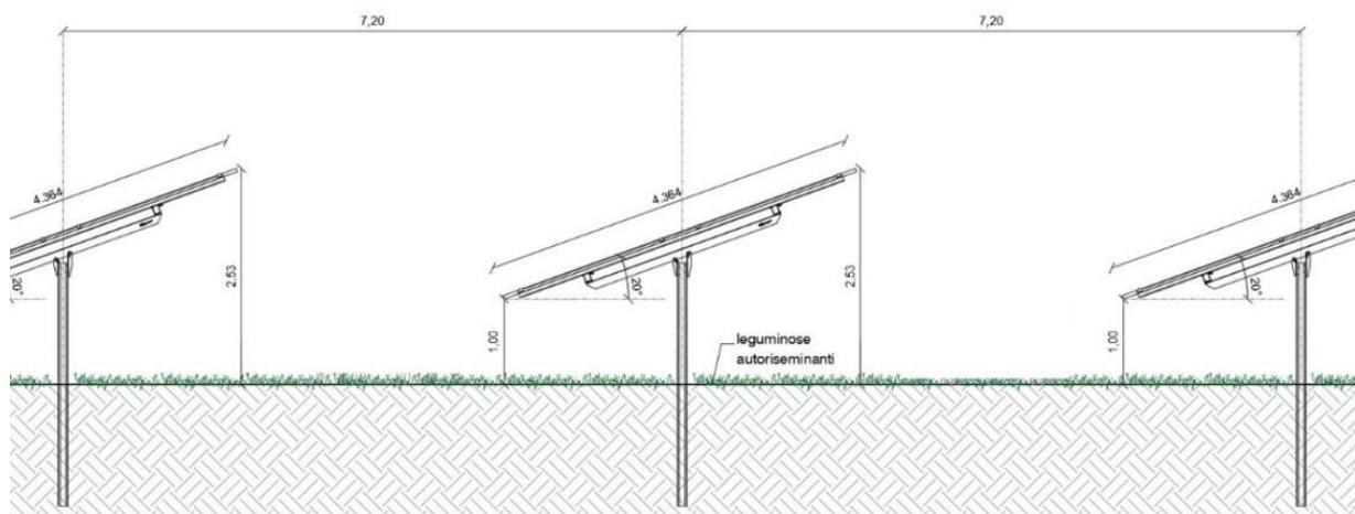
Figura 52: Particolare delle strutture di supporto dei moduli fotovoltaici
