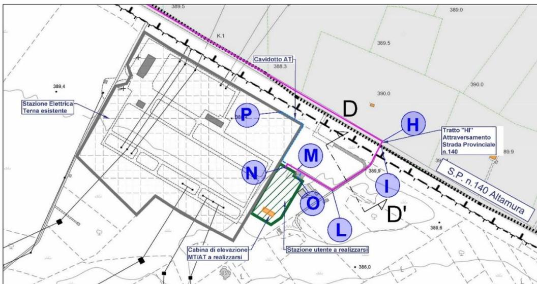
Figura 60: Percorso cavidotto AT di connessione alla SE "MATERA"
