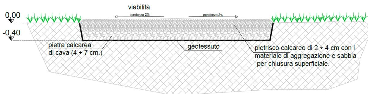
Figura 55: Sezione tipo della viabilità interna
