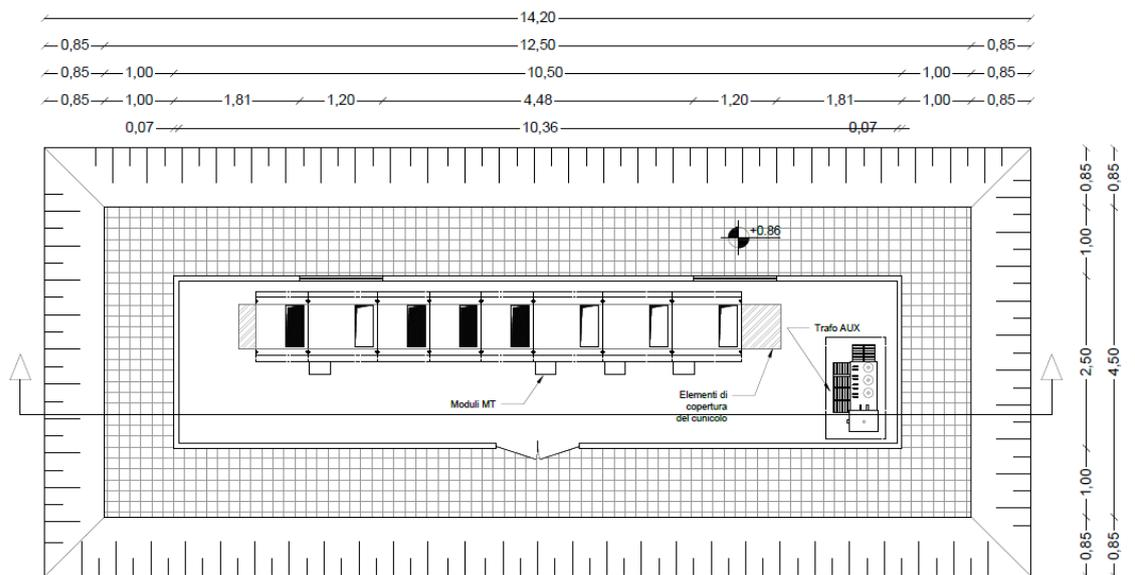
Figura 54: Planimetria cabina di raccolta
