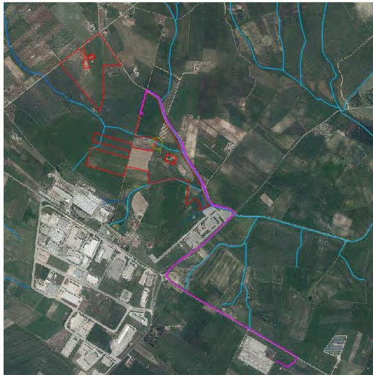
Figura 70: Sovrapposizione del reticolo idrografico e cavidotto – n.1 attraversamento
