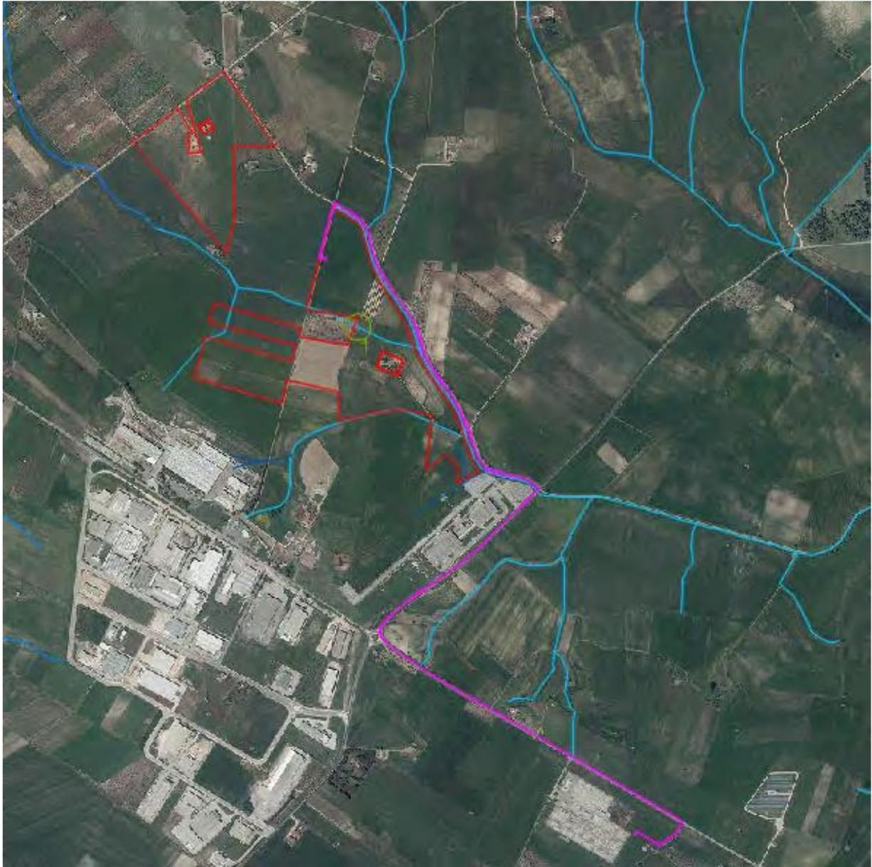
*Figura 45: Sovrapposizione del reticolo idrografico e cavidotto – n.2 attraversamenti*
