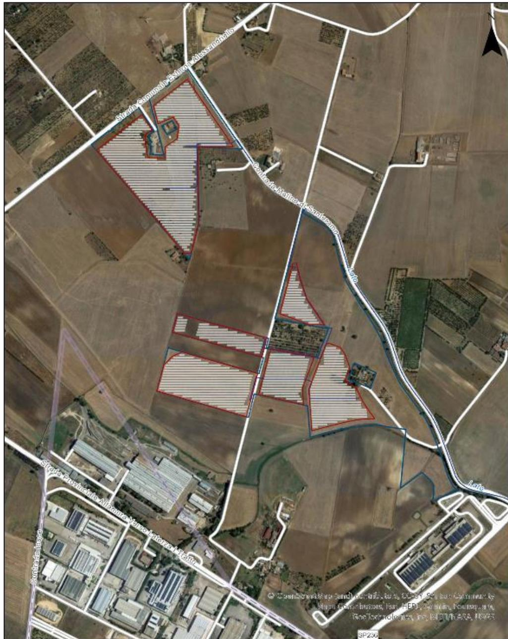
Figura 99: Layout impianto fotovoltaico in progetto
