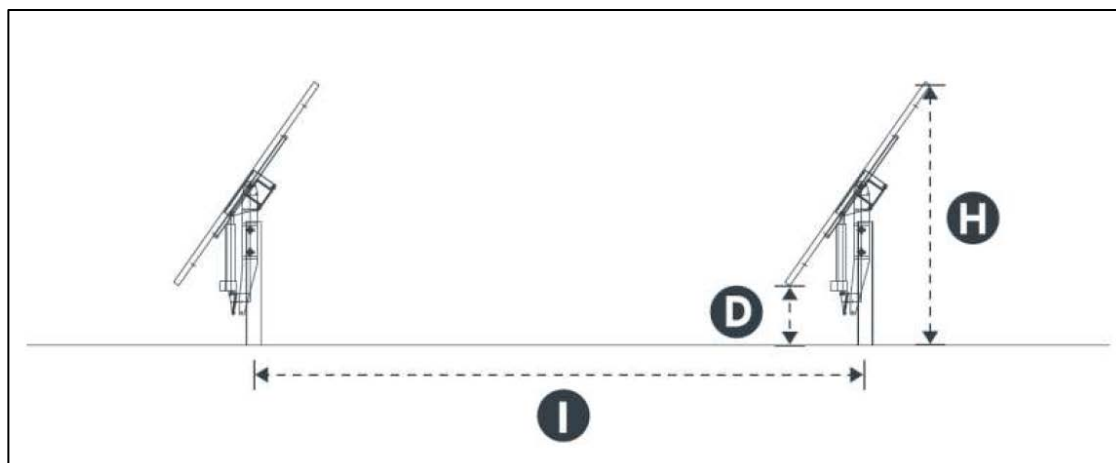
Figura 3: Definizione delle dimensioni
