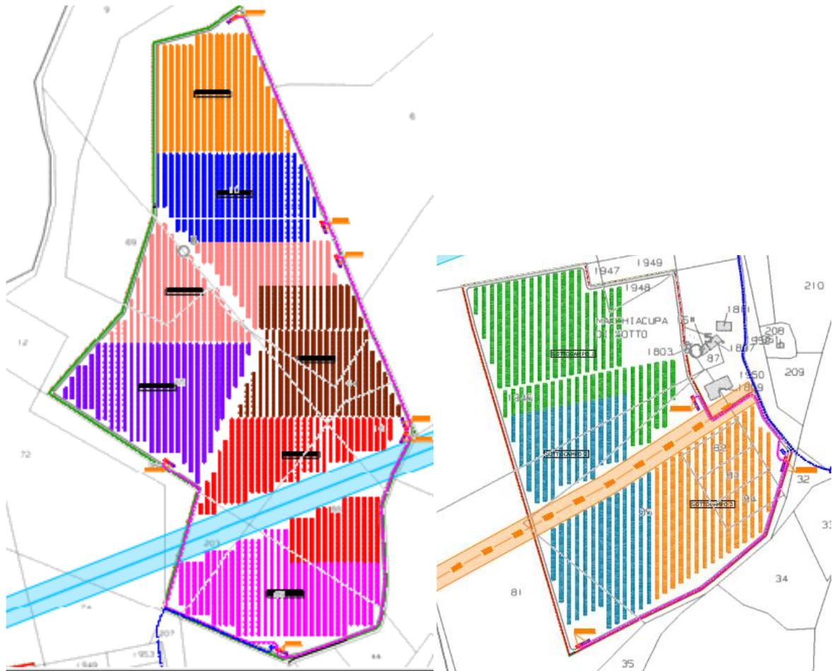
Figura 74 Planimetria con individuazione degli inverter in ciascuno dei sottocampi ai fini del calcolo
