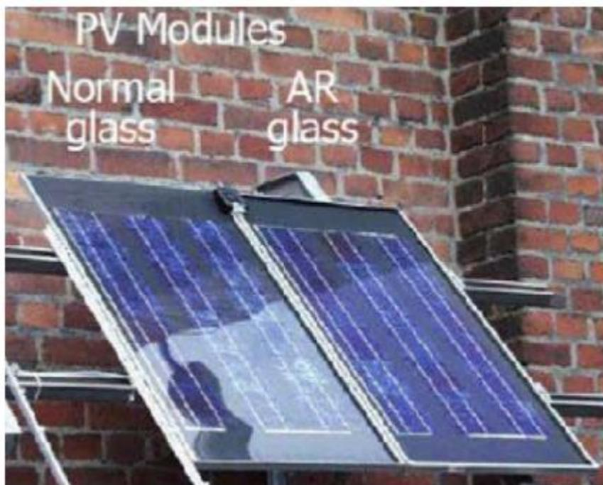
Al fine di minimizzare la quantità di radiazioni luminose riflesse, inoltre, le singole celle in silicio cristallino sono coperte da un rivestimento trasparente antiriflesso, grazie al quale penetra più luce nella cella. Senza tale rivestimento la sola superficie in silicio rifletterebbe circa il 30% della luce solare.
