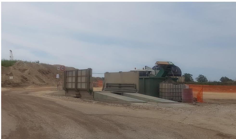
**Figura 71 Esempio di impianto automatico lavaggio ruote mezzi d'opera**
