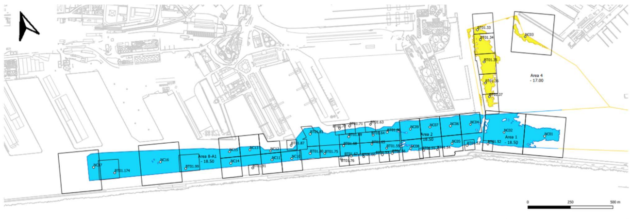
Figura 3-2: Area di dragaggio di “Fase 1”, bacino di Sampierdarena. In azzurro le aree con profondità di dragaggio pari a 18 m, in giallo quelle con profondità pari a 17 m. Tratta da “Progetto n°3062 caratterizzazione dei fondali marini del porto di Genova ai sensi del D.M. 173/2016”, Ambiente, marzo 2022.
