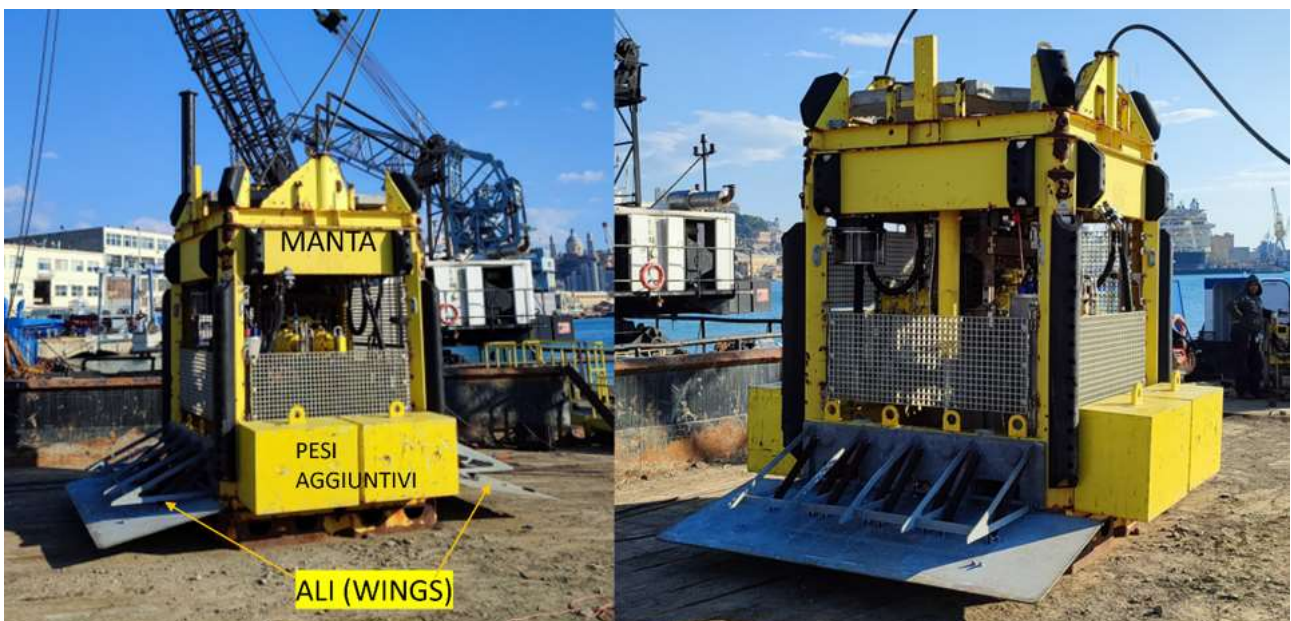
Figura 6-6: Dettagli del "seabed penetrometer" tipo "Manta" utilizzato per l'esecuzione delle prove CPT e DMT 2023
