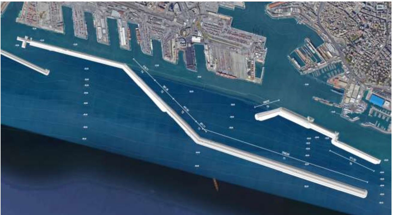
Figura 4-1: Planimetria della configurazione di progetto della nuova diga.
