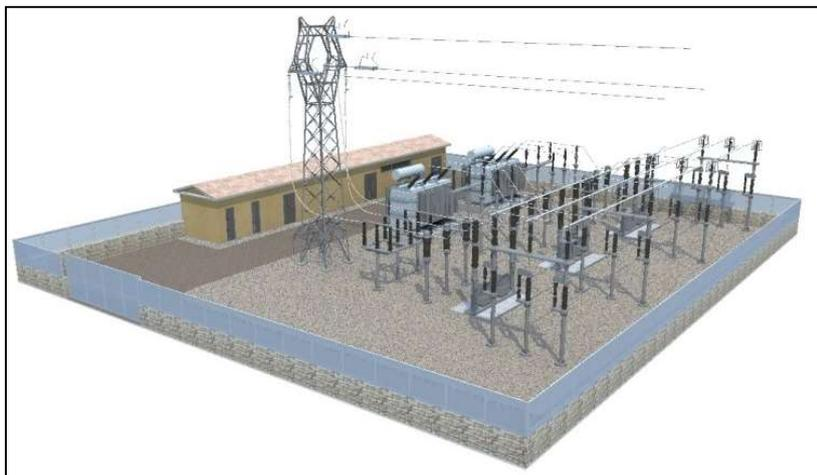
Figura 2-10 Sottostazione tipo con apparecchiatura ad alta tensione, trasformatore,
