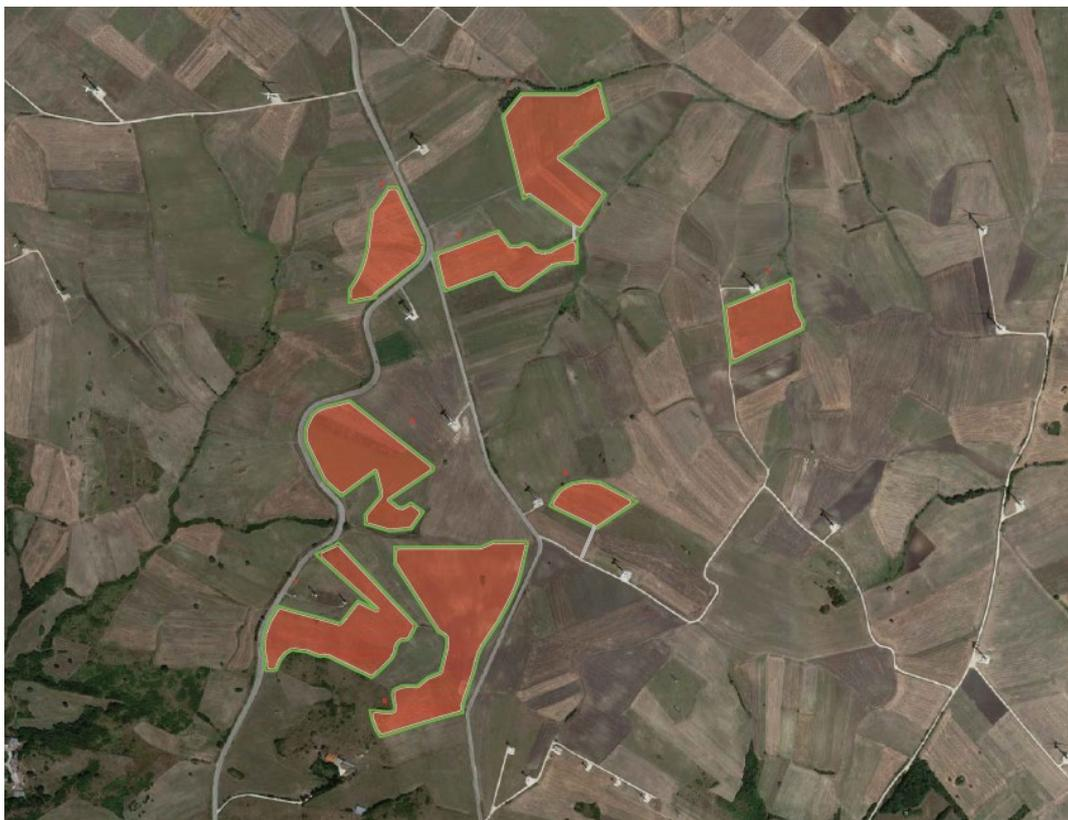
L'impianto fotovoltaico in progetto prevede l'installazione a terra, su un unico lotto di terreno di estensione complessiva di circa 256.800 m<sup>2</sup> attualmente a destinazione agricola condotti a seminativo, di pannelli fotovoltaici (moduli) in silicio monocristallino della potenza unitaria di 670 Wp.
