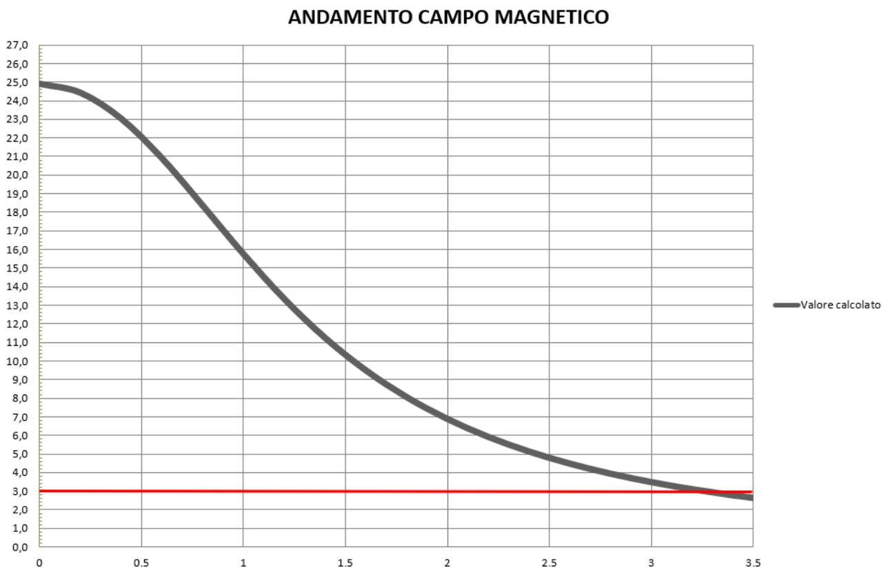
Valore dell'induzione magnetica al suolo del cavidotto MT nel tratto a 3 terne (n°1 da  $400 \text{ mm}^2$  e n°2 da  $630 \text{ mm}^2$ ) con disposizione in piano. Distanza dall'asse di posa dei cavi espressa in metri [m]
