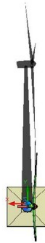
Fig. 2.2 – Proiezione dell'ombra indotta dall'aerogeneratore con rotore in linea con il sole ed il recettore
