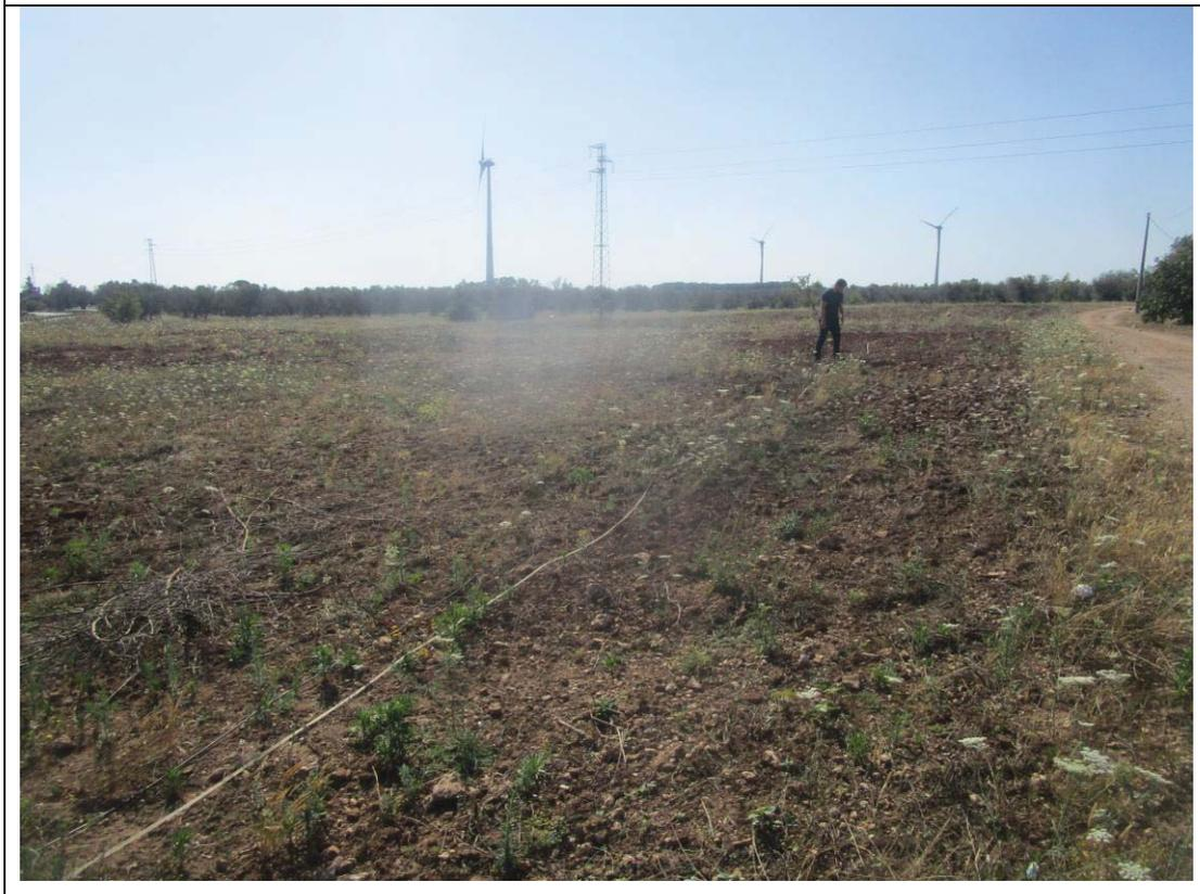
Dal profilo sismico E-E' della lunghezza di 55 metri si individua un modello stratigrafico caratterizzato da due sismostrati. In affioramento con  $V_p$  di 300 m/sec, si rileva del terreno vegetale, che presenta uno spessore di circa 0.3 metri; segue il secondo sismostrato che con una  $V_p$  di 1800 m/sec è da assimilare ad una calcarenite ben cementata.
