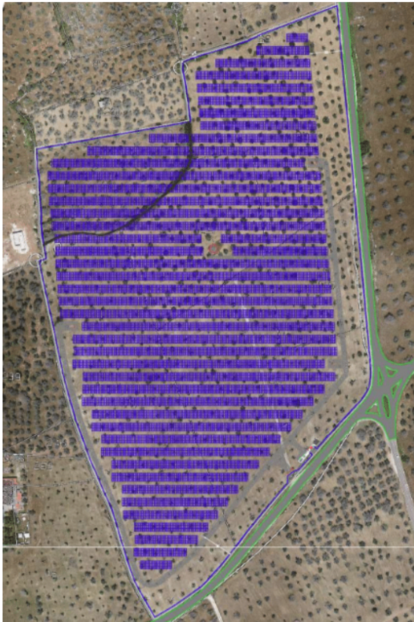
Immagine 2: Planimetria dell'impianto fotovoltaico
