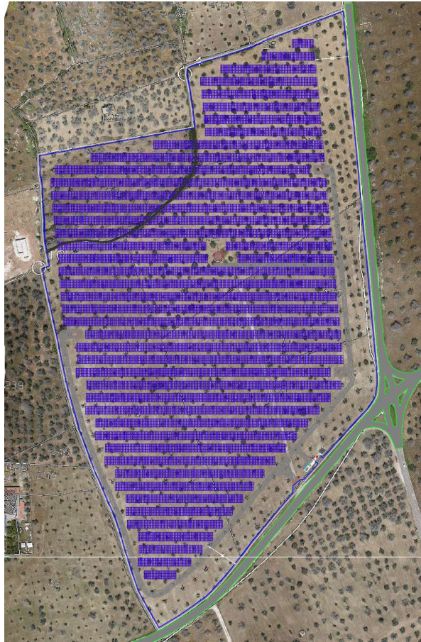
Figura 2 - layout dell'impianto fotovoltaico
