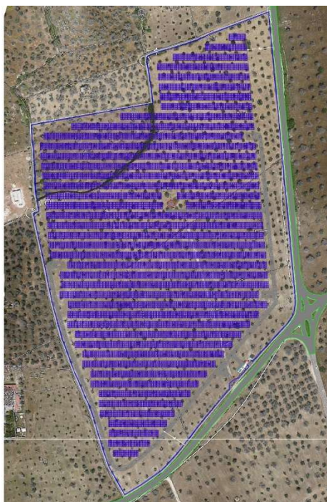
Figura 2 - layout dell'impianto fotovoltaico
