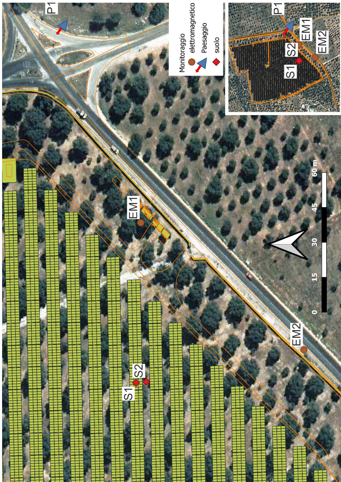
Fig. 3 – Localizzazioni dei punti di monitoraggio all'interno dell'impianto agrivoltaico.
