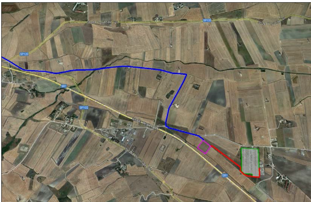
Figura 3 – Terreno destinato all'area SSEU (colore magenta) e percorso dell'elettrodotto interrato AT da realizzare (tratto in rosso).
