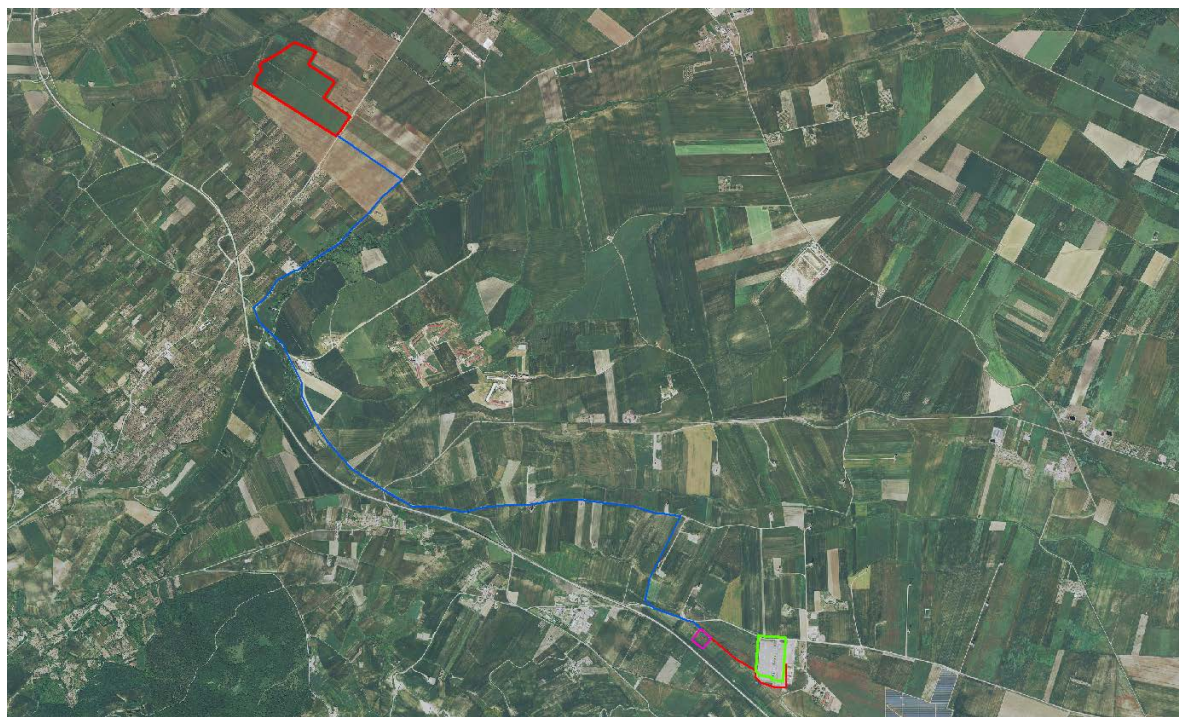
Inquadramento generale del progetto su base ortofoto Impianto Agro-voltaico (evidenziato in rosso) Percorso dell'elettrodotto interrato MT da realizzare (tratto in blu) Area SSE Utenza (colore magenta) e percorso dell'elettrodotto interrato AT da realizzare (tratto in rosso)
