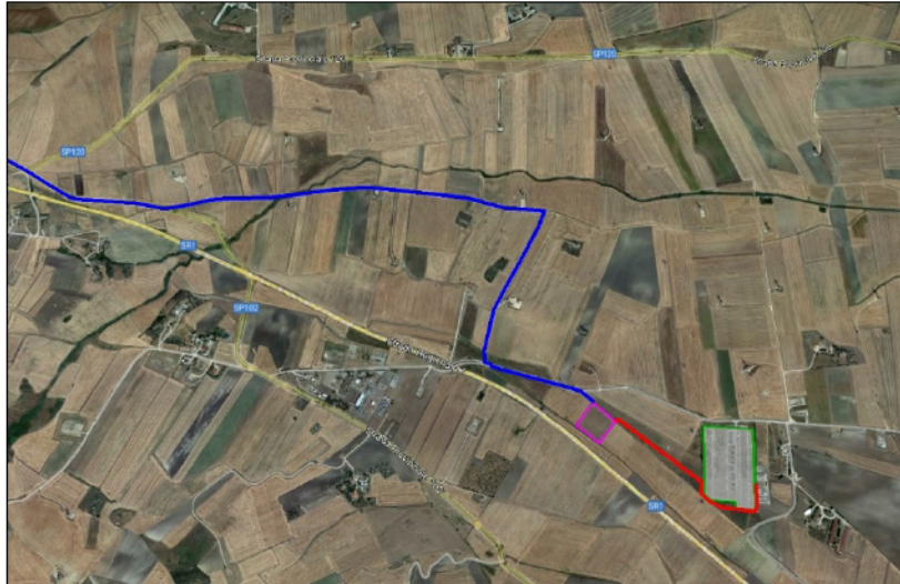
Fig. 3 – Area SSEU (colore magenta) e percorso dell'elettrodotto interrato AT da realizzare (tratto in rosso).
