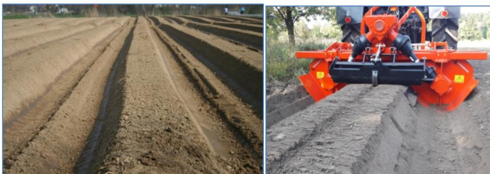
Baulatura del terreno per la coltivazione di asparago e macchina per la baulatura (baulatrice)
