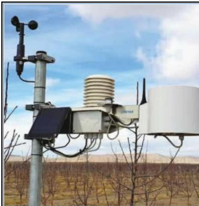
Centralina agrometeorologica dotata di pluviometro, radiometro, termoigrometro, anemometro.
