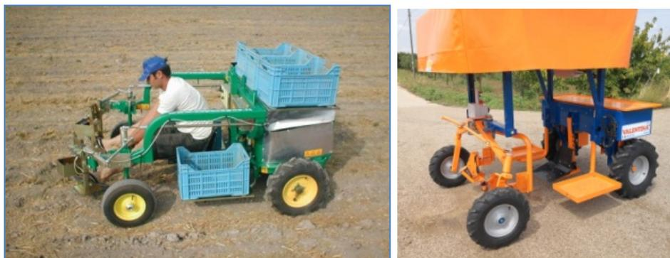
Per la destinazione dell'asparagiaia all'industria conserviera, vengono utilizzate macchine che possono operare automaticamente raccolta e una selezione. Sono macchine a "lavoro integrale",
