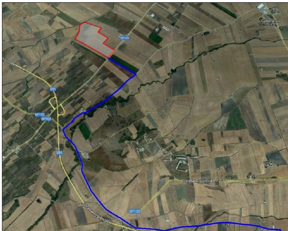
*Figura 9. Percorso dell'elettrodotta interrato MT da realizzare (tratto in blu).*
