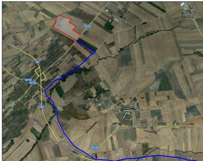
Figura 3. Inquadratura su ortofoto dell'area occupata dall'impianto con relativo percorso dell'elettrodotto interrato
