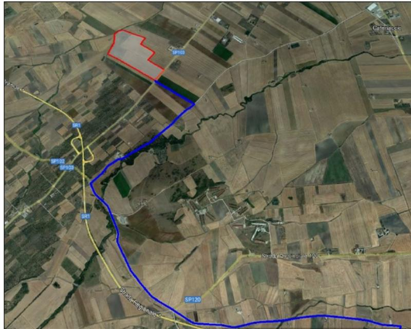
*Fig. 2 - Percorso dell'elettrodotto interrato MT da realizzare (tratto in blu).*
