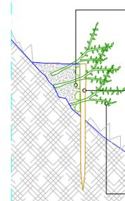
Pali di legname di castagno della lunghezza di 2,20 m circa, infissi per una profondità di 1,2 m circa, posti ad un interasse di 1 m. diam. Ø15 e bitumati sulla punta per 1,20 m
