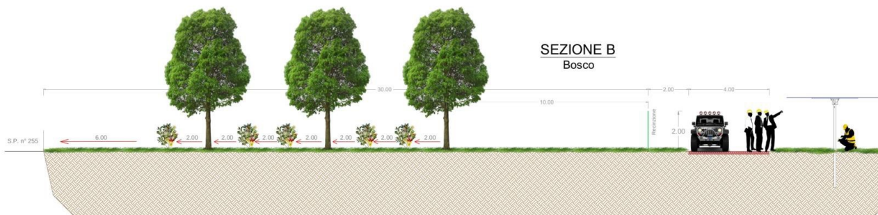
Figura 13 – Sezione tipo d’impianto del bosco
