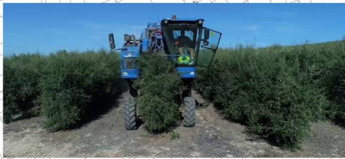
Macchina scavallatrice durante le operazioni di raccolta in oliveto superintensivo a siepone
