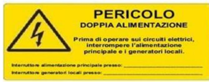
Figura 17 - Segnaletica da utilizzare per i lavori sugli impianti FV
