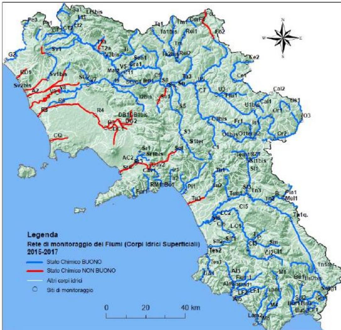
Figura 4.10 -Classificazione dello Stato Chimico dei corpi idrici fluviali della Campania nel triennio di monitoraggio 2015/2017 (Fonte: ARPAC)
