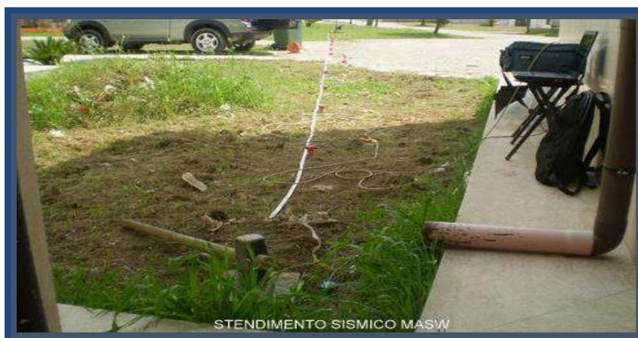
**Figura 2: ESEMPIO DI STENDIMENTO SISMICO**
