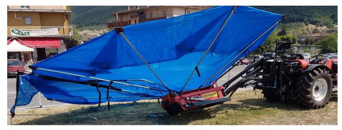
L'organizzazione del campo, come prima rappresentata, garantisce anche l'esercizio della ordinaria manutenzione di pulizia dei pannelli fotovoltaici che viene effettuata con mezzi meccanici in grado di percorrere agevolmente i filari coltivati utilizzando macchinari simili, per caratteristiche, a quelli in uso al mondo agricolo senza arrecare disturbo o danno.
