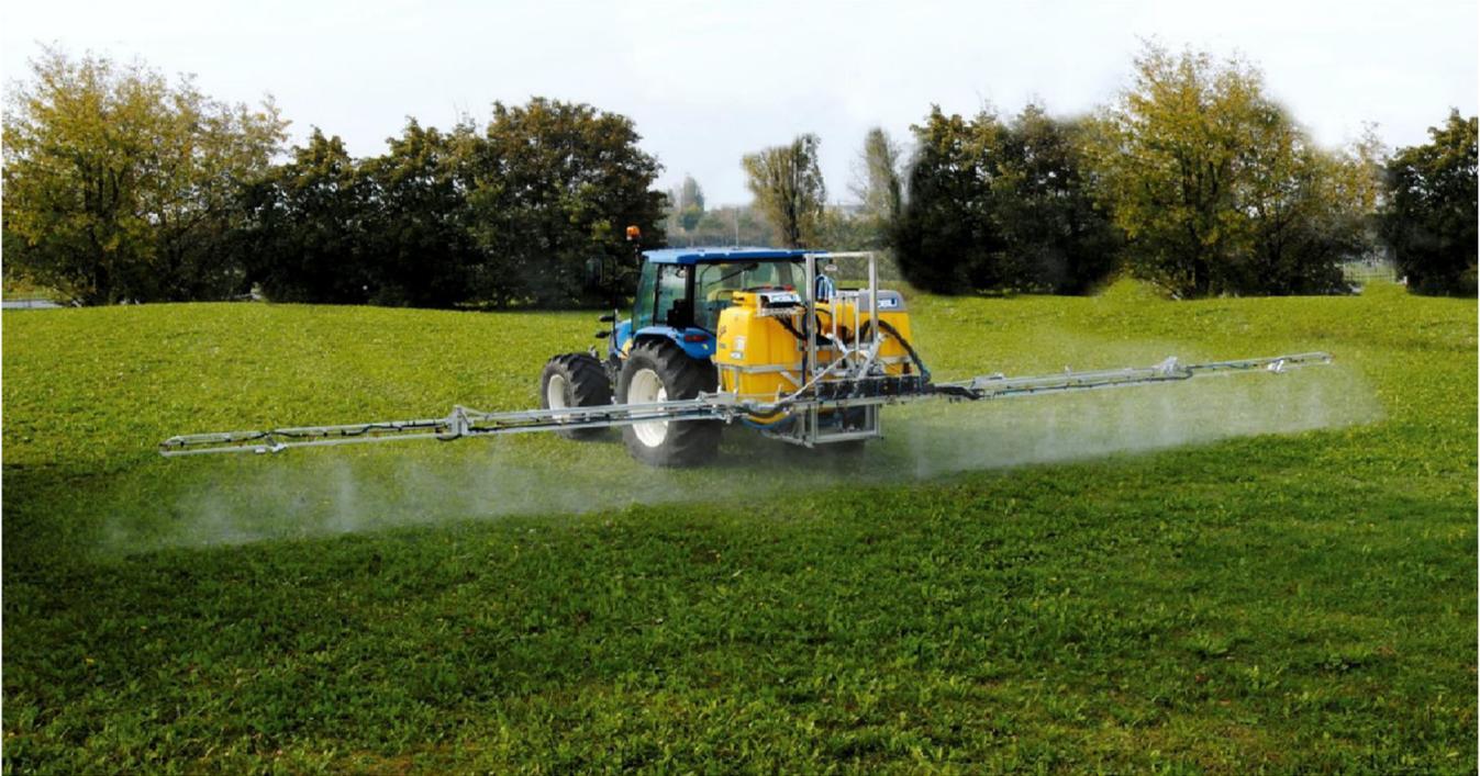
*Figura 6 Barra irroratrice con ugelli antideriva*
