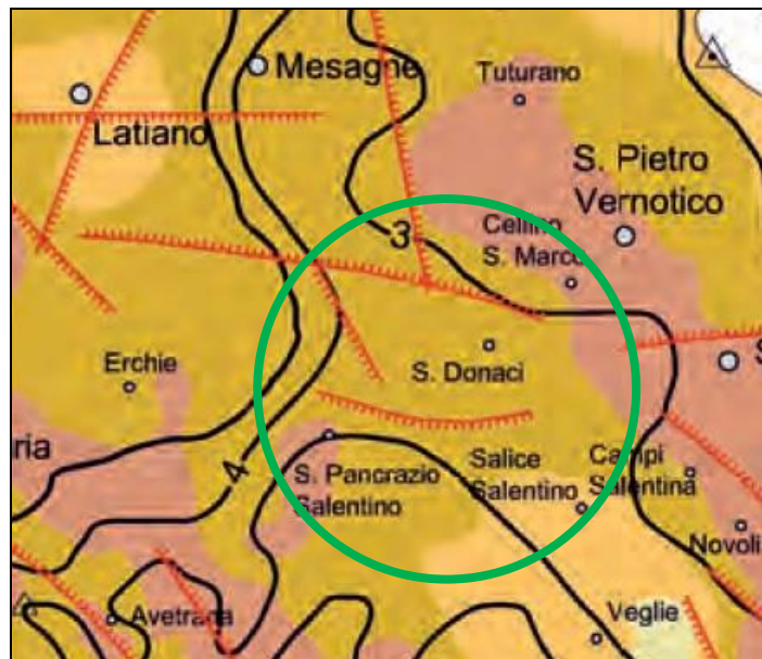
Curve isopiezometriche dell'acquifero carbonatico (metri s.l.m.). In verde l'area delle opere in progetto
