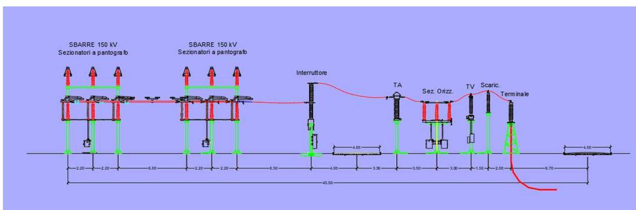
Figura 3 – sezione stallo RTN di connessione
