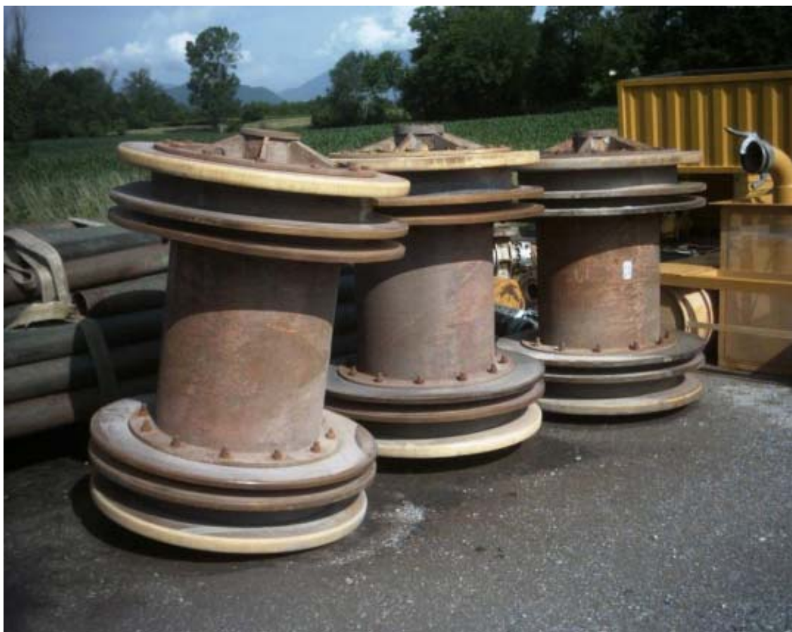
Foto 7.1.13/B - Pig per collaudo idraulico
