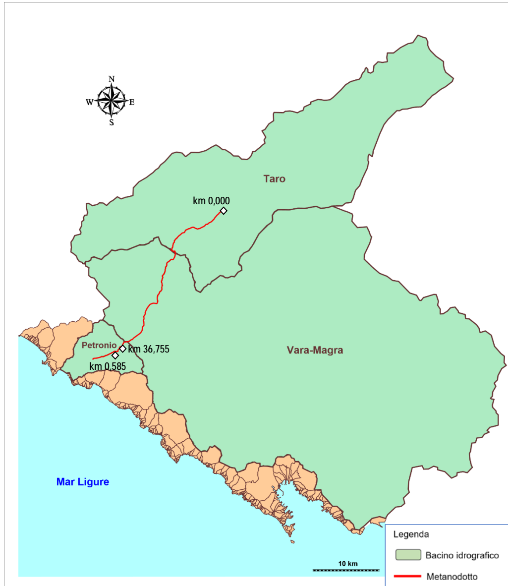
Fig. 4.1/B - Bacini idrografici attraversati dal metanodotto
