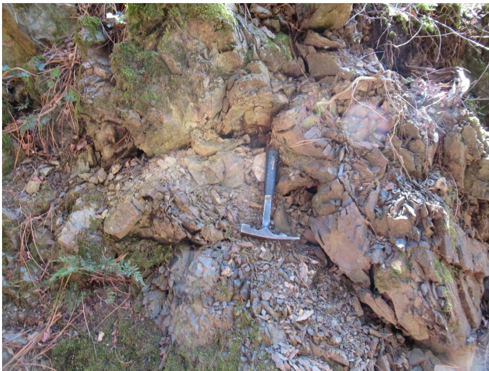
Fig. 4.4/E: Affioramento di Argille a palombini lungo il sentiero di quota 400 - 425 m s.l.m., nel corpo di frana.
