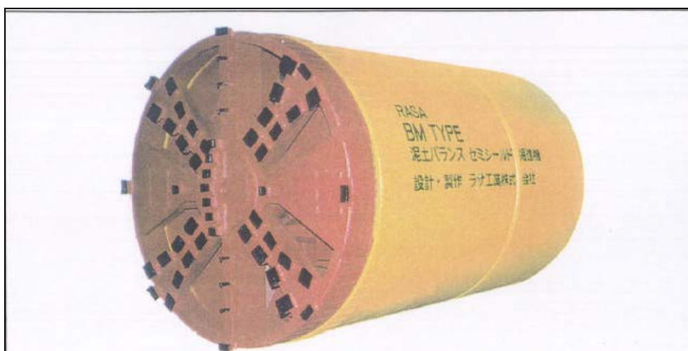
Scudo con bilanciamento pressione meccanica del terreno (microtunneller)
