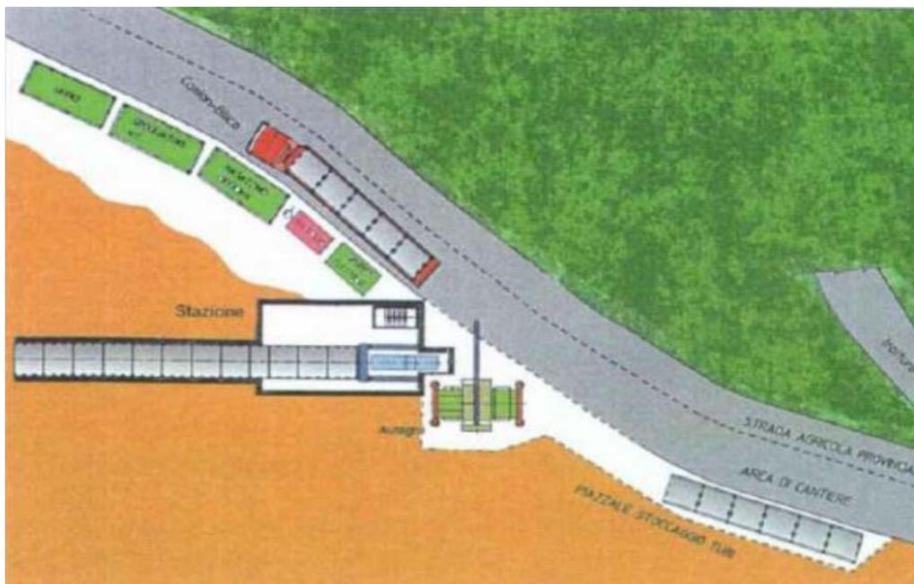
Fig. 5/E - Schema tipo di un cantiere per l'installazione di un microtunnel
