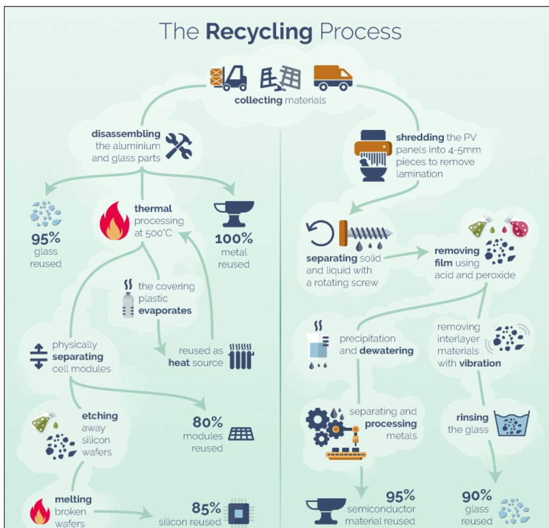
**Figura 57.** Il processo di riciclo dei moduli fotovoltaici a base silicea e dei sottoprodotti della dismissione di impianti fotovoltaici. Fonte: [www.greenmatch.co.uk/blog/2017/10/the-opportunities-of-solar-panel-recycling](http://www.greenmatch.co.uk/blog/2017/10/the-opportunities-of-solar-panel-recycling) (Ultimo aggiornamento: marzo 2021).
