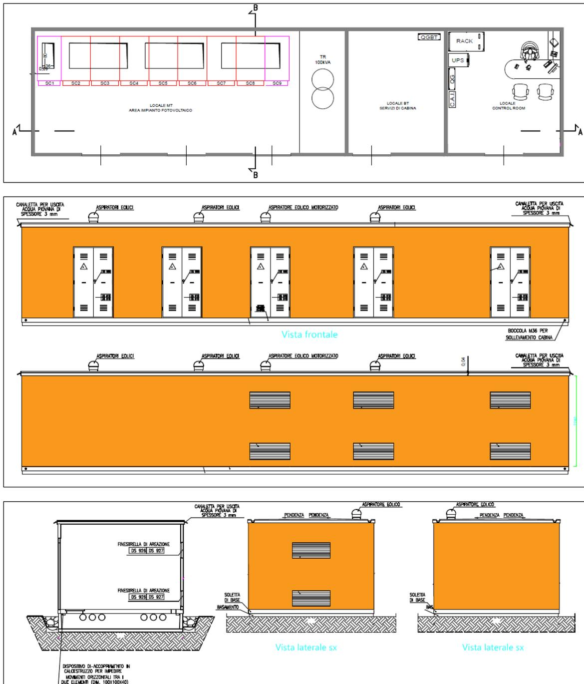
Figura 43. Vista in pianta/prospetto/seziona della cabina di smistamento a 30kV e sala di controllo.
