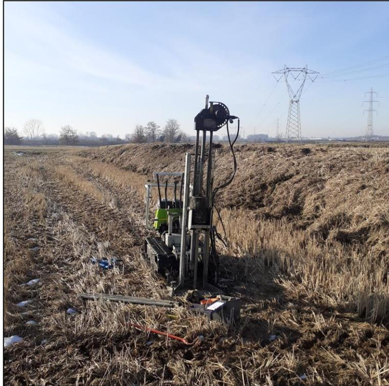
**Foto 3.** Prova penetrometrica P3.
