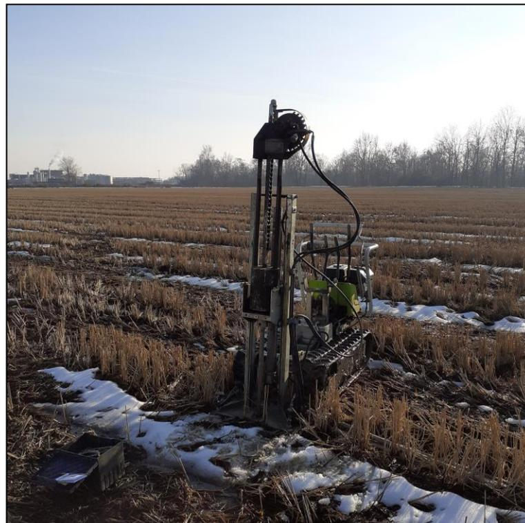
**Foto 20.** Prova penetrometrica P20.
