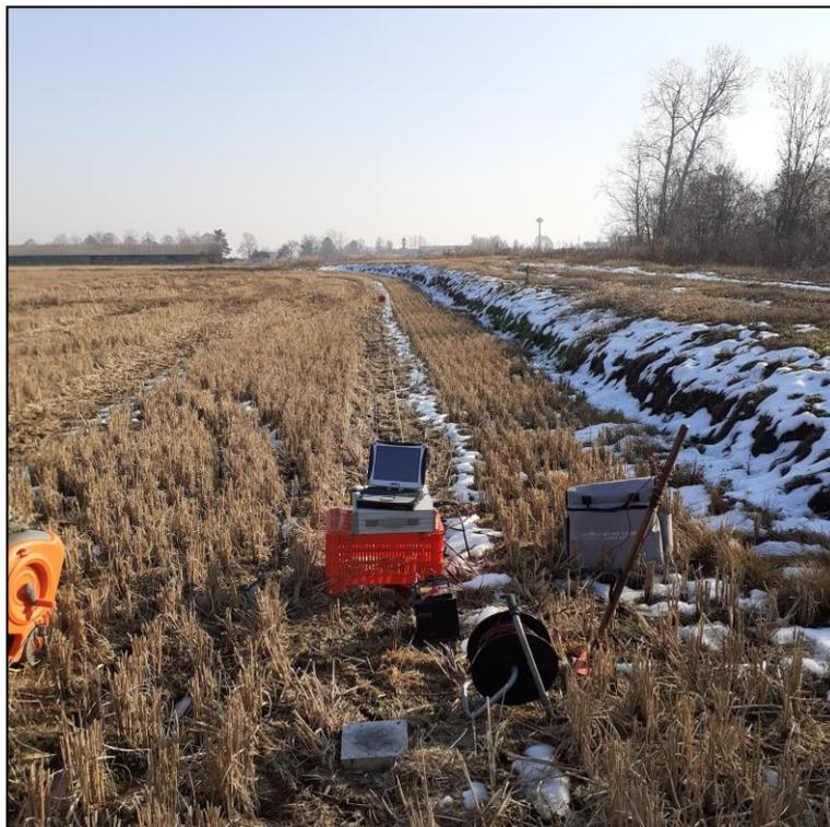
Foto 28. Prova sismica MASW S4.
