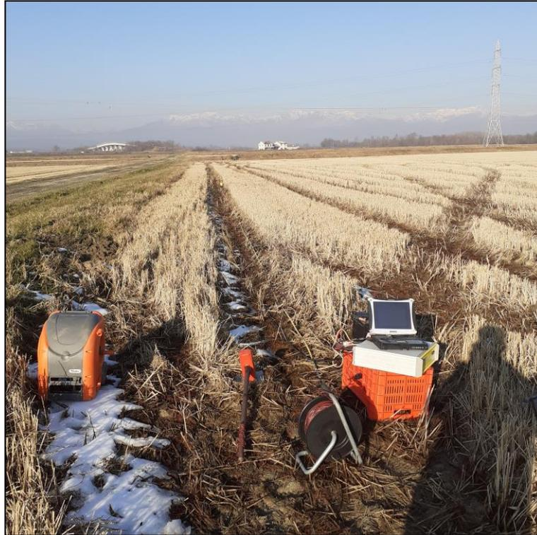
Foto 25. Prova sismica MASW S1.
