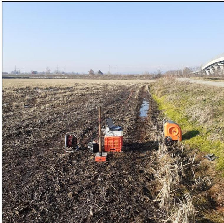
Foto 26. Prova sismica MASW S2.
