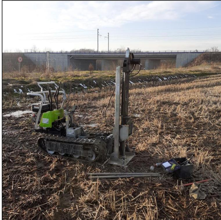
Foto 11. Prova penetrometrica P11.
