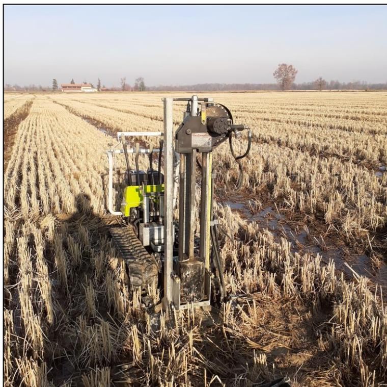
**Foto 21.** Prova penetrometrica P21.
