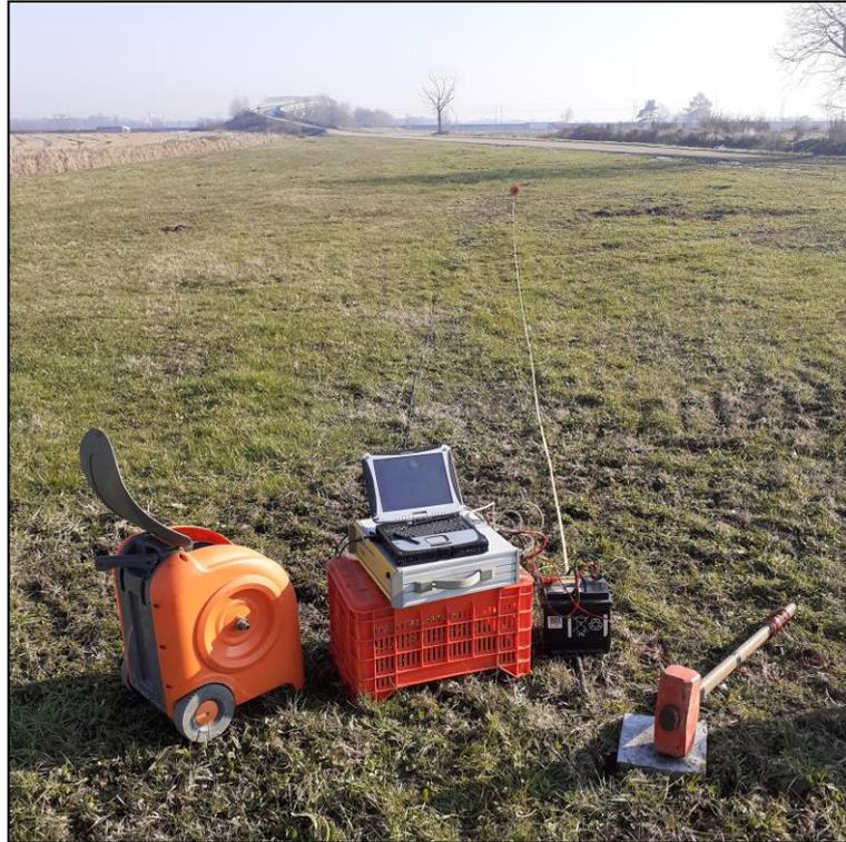
Foto 27. Prova sismica MASW S3.
