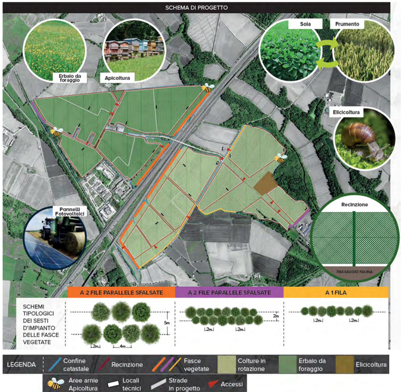
Figura 25. Distribuzione spaziale della proposta agrivoltaica del progetto (rif. FTV22CP05-AMB-R-08c). Le linee arancioni viola e gialle, rappresentate in planimetria, identificano gli ambiti di piantumazione di fasce boscate e filari vegetati con sesto di impianto tipologico rappresentato nella parte bassa dell’immagine (e dei quali viene data ampia trattazione al Cap.6.2).
