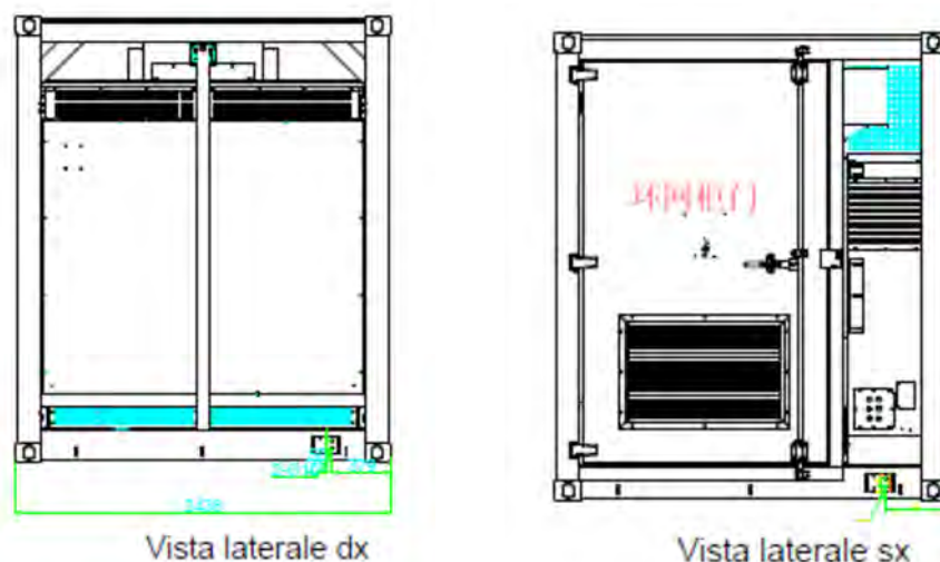
Figura 30. Caratteristiche dimensionali dell'unità di trasformazione (vista laterale dx e sx).
