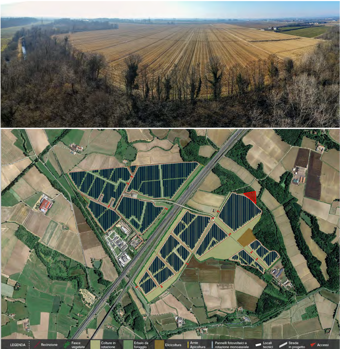
Figura 43. Sovrapposizione di layout di progetto agrivoltaico su ortofotocarta con evidenza dei margini boscati esistenti (fotografia panoramica nella parte sommitale della figura scattata nel margine est di progetto) e delle fasce vegetate di mitigazione.
