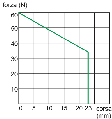
Figura 1: questo grafico mostra il valore della forza rilasciata dal percussore in base alla lunghezza della corsa.
