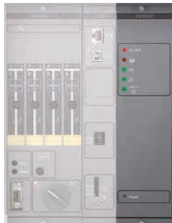
Alimentazione di emergenza
