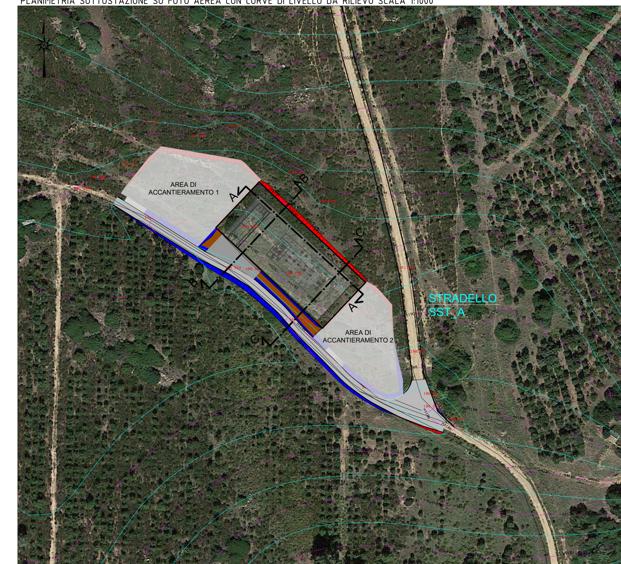
PLANIMETRIA SOTTOSTAZIONE SU FOTO AEREA CON CURVE DI LIVELLO DA RILIEVO SCALA 1:1000
