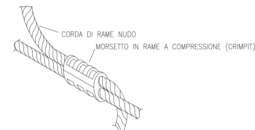
PARTICOLARE MORSETTO A COMPRESIONE
